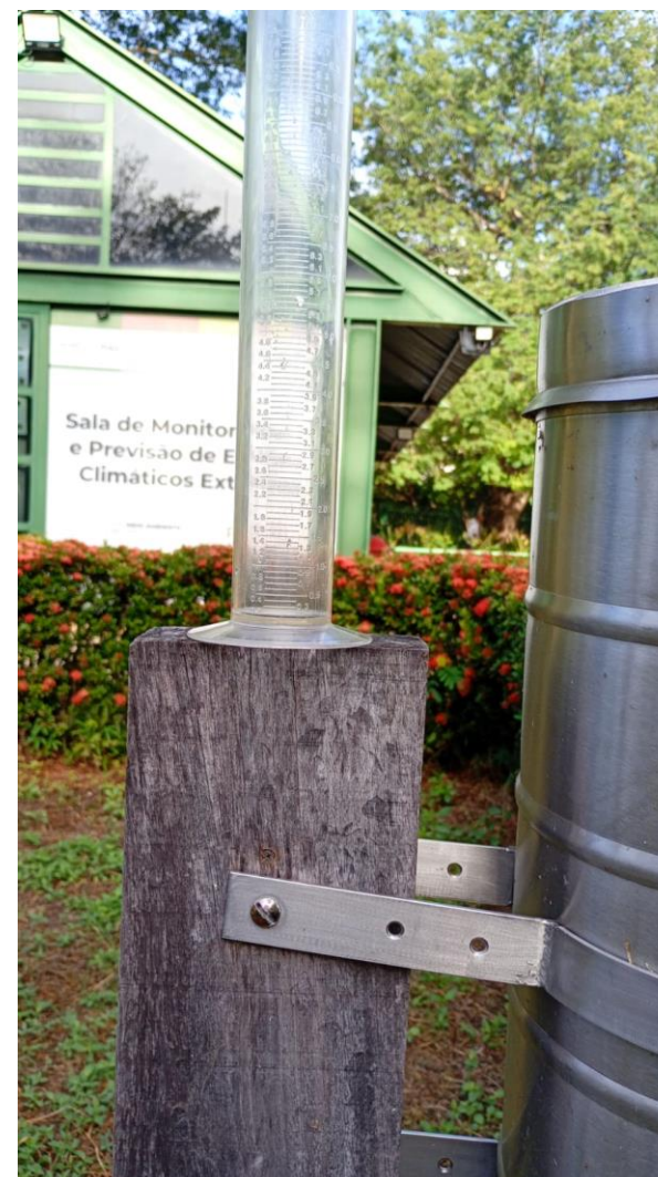
Pluviômetro – sem chuva
